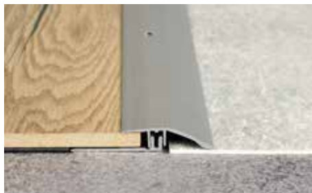
Vyrovňavacie profily, 44 mm pre podlahy hrúbky 6,5 až 16 mm
